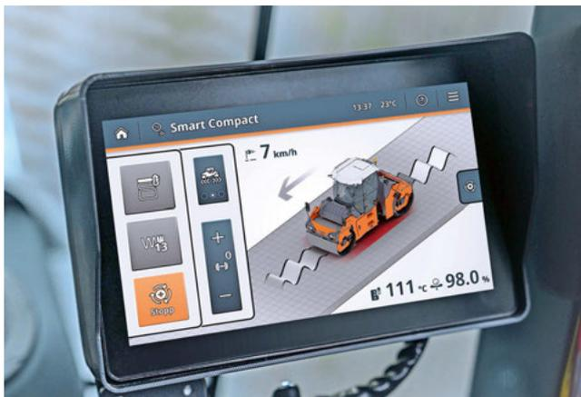
**Integration von Echtzeit-Dichte in Smart Compact:** Die automatische Regelung der Verdichtungskraft und -modi auf Basis der Echtzeit-Dichte (auf dem Display unten rechts in Prozent).
