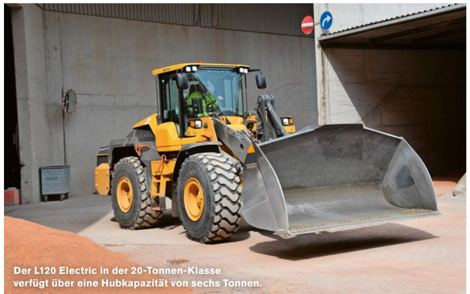
Der L120 Electric in der 20-Tonnen-Klasse verfügt über eine Hubkapazität von sechs Tonnen.
