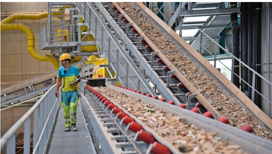
Im Aufbereitungszentrum für Bauabfälle werden die Materialien grob vorsortiert und zerkleinert.
