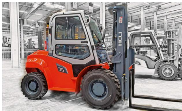
**Der CPCD 35 mit Vollkabine, Allradantrieb und Triplex-Hubgerüst ist für den mitteleuropäischen Markt der wichtigste Heli-Geländestapler mit 3,5 Tonnen. (Foto: pd)**
