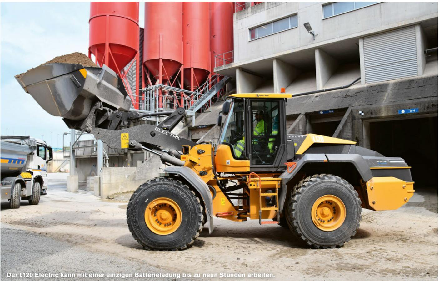
Der L120 Electric kann mit einer einzigen Batterieladung bis zu neun Stunden arbeiten.
