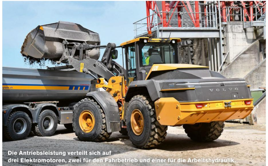
Die Antriebsleistung verteilt sich auf drei Elektromotoren, zwei für den Fahrbetrieb und einer für die Arbeitshydraulik.
