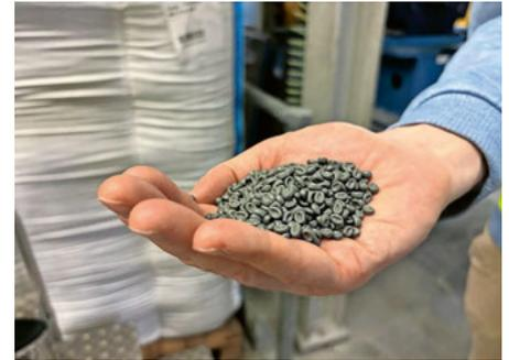
**Granulat aus rezyklierten FPO-Dachbahnen:** Ziel des Pilotprojekts ist, kreislauffähige Materialien wieder in neue Produkte zu integrieren.
