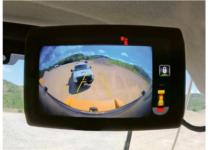
**Befindet sich ein Hindernis in der Spur des Radladers, wird dieser automatisch verlangsamt.**
